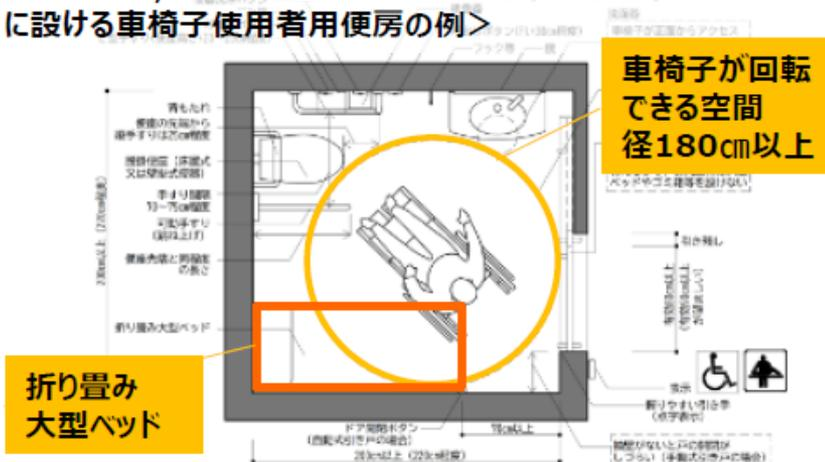
円滑化基準で定めている『車椅子使用者が円滑に利用できるよう十分な空間の確保』について、建築設計標準でガイドされています。
